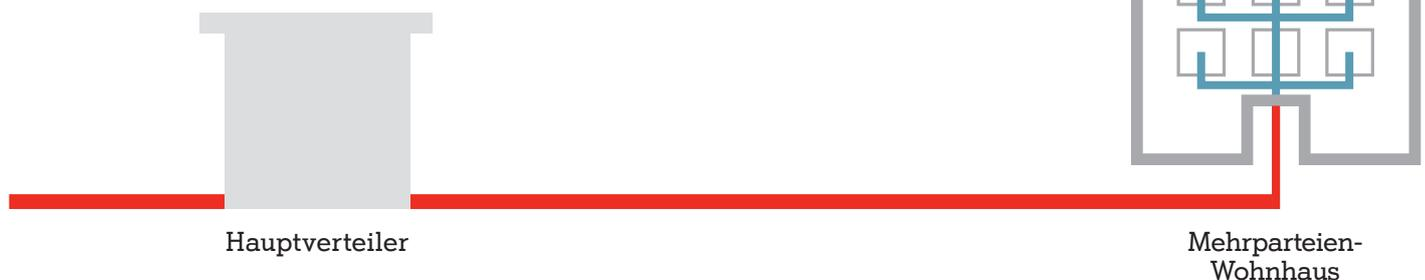
Bei „Fibre to the Building“ wird ein Glasfaserkabel in den meist zugänglichen Keller geführt. Dort werden alle vorhandenen Telefon- und Datenleitungen damit zusammengeführt und bleiben somit im Rest des Gebäudes völlig unangetastet.
